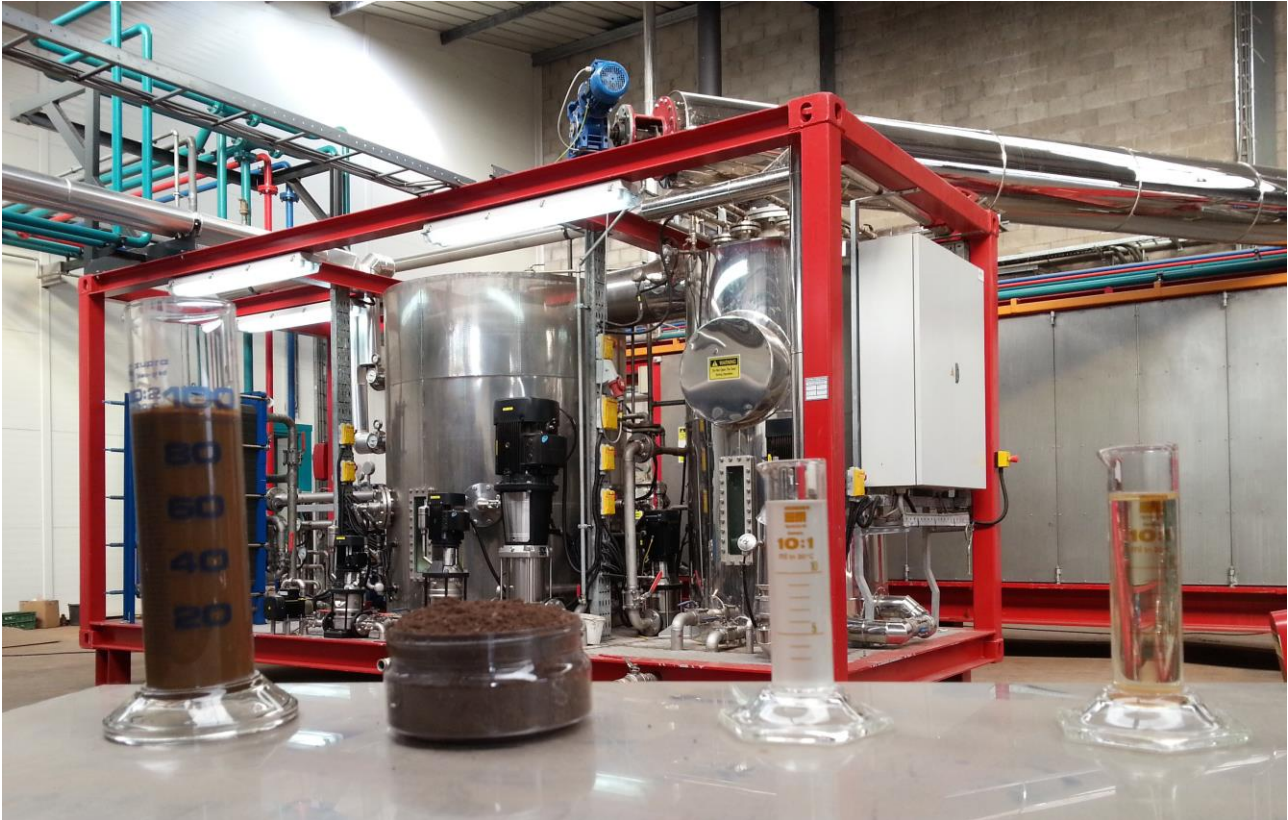
Anlægget separerer bore-slammet (t.v.) i henholdsvis tørstof, vand og olie
