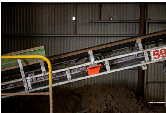
Vægt under produktionsbåndet, der er forbundet til SIWAREX WP341
